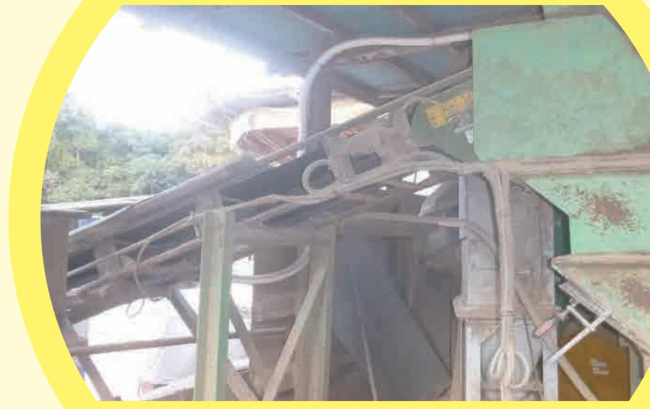
一次破碎された瓦チップを二次破碎機に流し再破碎
