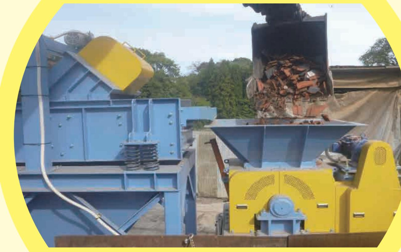
受け入れされた廃瓦を前処理施設に投入し一次破碎
