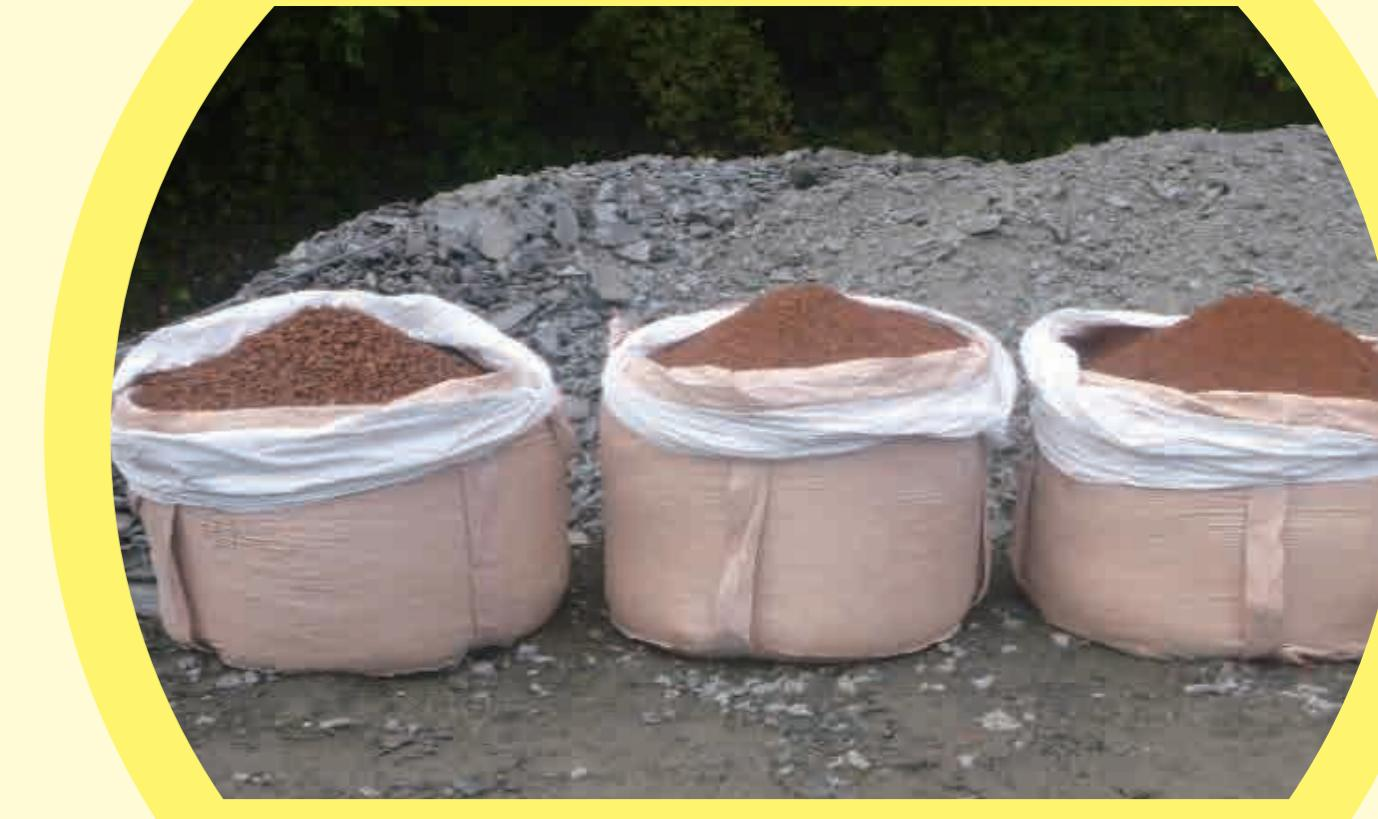
破碎された瓦チップは自動フリイ機により粒度調整し、搬出され製品化
